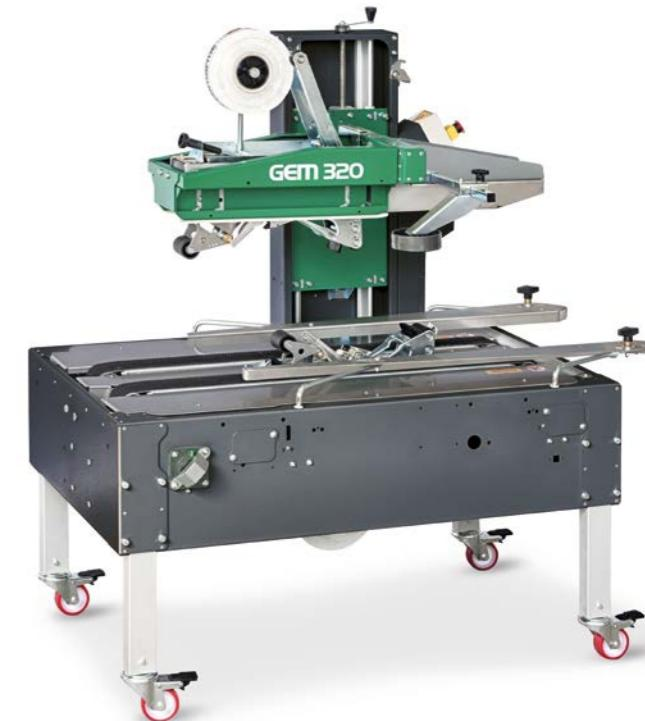
GEM 320 è dotata di un sistema di avanzamento delle scatole ottenuto mediante **nasti di trascinamento inferiori orizzontali**. Il gruppo nastrante superiore è dotato di un sistema brevettato che consente mediante la regolazione di una molla di predeterminare il peso che andrà a gravare sulla scatola e di assorbire, quindi, eventuali differenze in altezza delle scatole.
